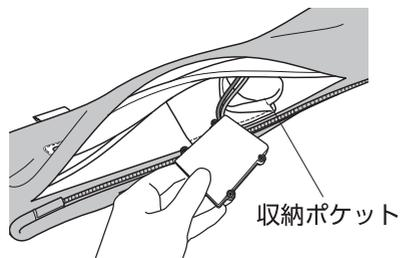
**3** 充電電池カバーのネジ(4箇所)をドライバーを使ってはずします。
